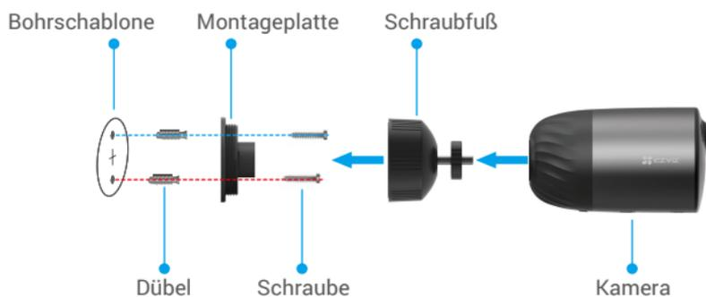
Abb. 2 Montage mit Schraubfuß
