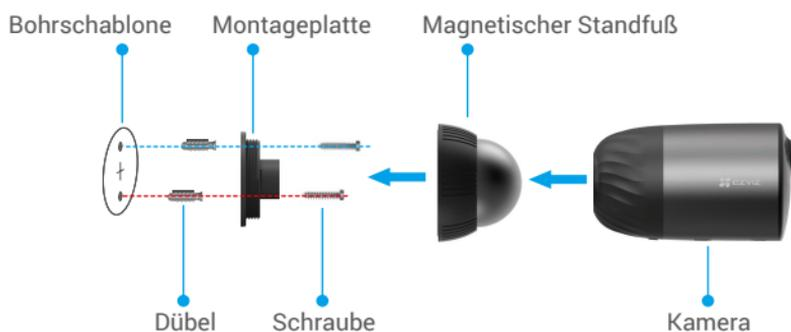
Abb. 1 Montage mit Magnetfuß
